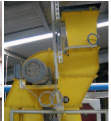
Elevatorkopf mit Druckentlastungsöffnung, Schiefelaufüberwachung und Verschleißschutz (links)
