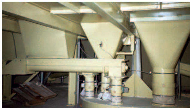
Schneckendosierung für Lebensmittelmehle
